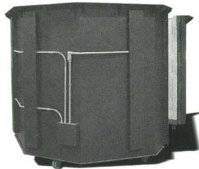
Großer Klapp-Tieföfen, 1800 °F (982 °C), Durchmesser 74" (1,8 m), Höhe 82" (2,1 m), konstruiert für einen Hersteller von Spezialmetallen
