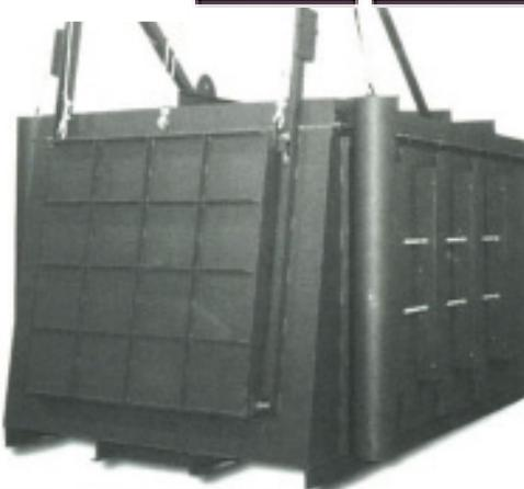
Камерная печь с передней загрузкой, 2200°F (1204°C), для дозированной термообработки
